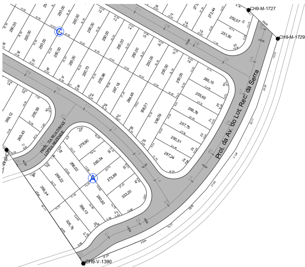
Figura 20– Detalhe do prolongamento da avenida marginal, integrando os loteamentos Recanto da Serra I e II.
